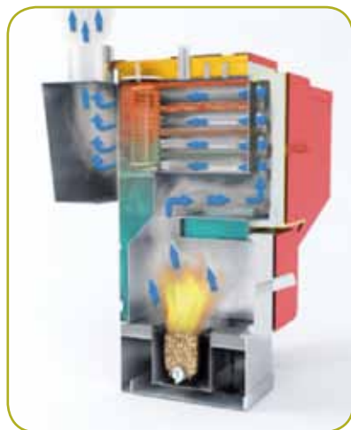
Figura 12.- Esquema de funcionamiento de la caldera. Fuente: CT Pasqualicchio
