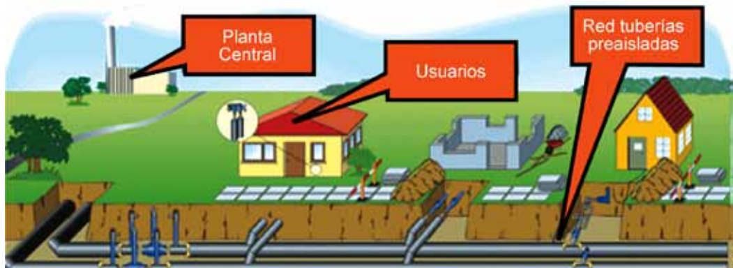
Figura 13.- Esquema de una central de distribución de calor. Fuente: IDAE.
